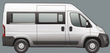
Jumper Combi 33 L2H2 - 9 miest: dĺžka 5413 mm - vonkajšia šírka 2050 mm - vonkajšia výška 2524 mm.
